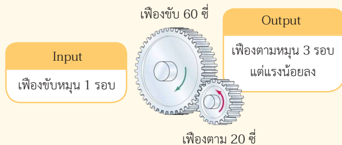
รูป 2 การทำงานของเฟืองตรงเพื่อลดแรงและเพิ่มความเร็ว
